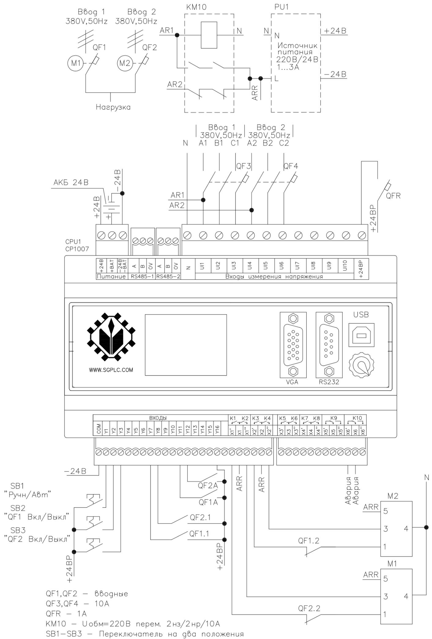
ШКАФ АВТОМАТИЧЕСКОГО ВВОДА РЕЗЕРВА ( АВР )
